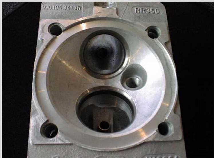
Austausch-Zylinderkopf ohne Ventile 3,3 l Turbo
