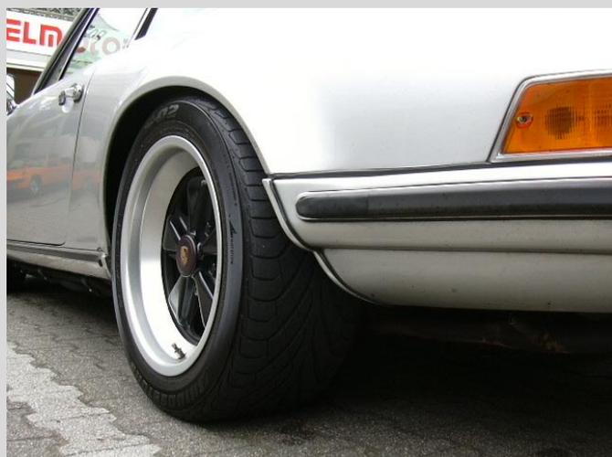
Wie nebenstehend abgebildet lassen sich bei allen 911 Modellen mit Carrera Verbreiterungen, sowie bei allen Modellen von '78 - '89 problemlos auch die 9J x 16 Fuchs Felgen vom Turbo montieren.
