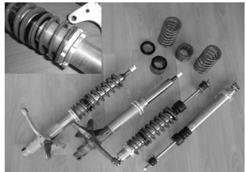
Bilstein Schraubenfederfahrwerk vom 911 RSR mit versetztem Achsschenkel für tiefergelegte Fahrzeuge, Höhe über Gewinde einstellbar, H & R Sportfedern mit Zusatzfedern (Federungsprogression) für den Strasseneinsatz verwendbar. Kompletter Kit mit Federn, Dämpfern, Aluminium-Domlagern mit Kugelgelenken, Federtellern, Zwischenringen und Endanschlagfedern.
