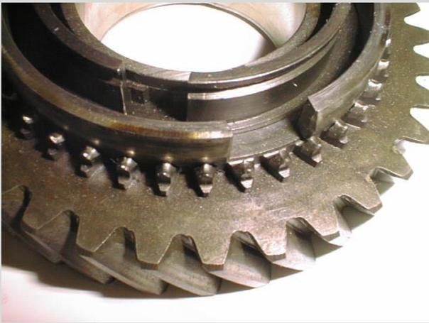
Da die Gangräder selbst aber sehr selten Schäden aufweisen, lassen sich diese durch die Einpressung eines neuen Kupplungskörpers aber wieder in einen neuwertigen Zustand versetzen. Für diesen Fall können Sie bei uns sowohl den Kupplungskörper einzeln bestellen, als auch ein überholtes Gangradpaar
