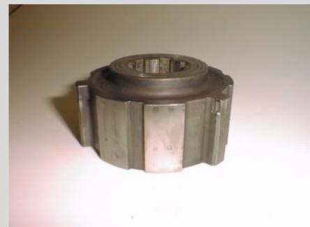
Ein unbeabsichtigter Gangwechsel von einem hohen in einen niedrigen Gang, kann das sofortige Aus einer Schaltmuffe einschließlich des dazugehörigen Synchronrings bedeuten.
