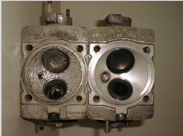
links: defekter Zylinderkopf eines 3,0 l Sechszylinder-Motors, rechts: Austausch-Zylinderkopf 3,0.
