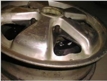
In dieser Ausbaustufe können – im Gegensatz zur 993 Turbo Bremsanlage – auch noch 15 Zoll Felgen verwendet werden. Abgebildet ein Extrembeispiel: 3,2 Carrera Dämpferbein mit 986 Aluminium 4-Kolben Bremsattel in Verbindung mit Felge Fuchs 4,5J x 15.
