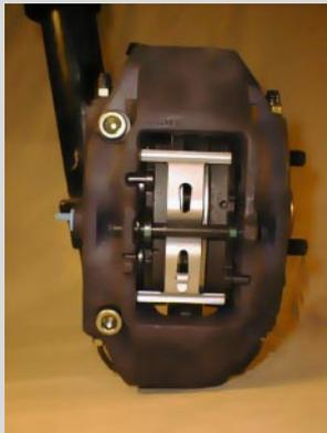
Hinweis: Die oben genannten Kits sind verwendbar für alle 911 bis '83. Ab '84 sind hinten, neben den jetzt 24 mm statt 20 mm dicken Bremscheiben, auch Bremsästel mit 42 mm statt 38 mm Kolbendurchmesser verwendet worden.
