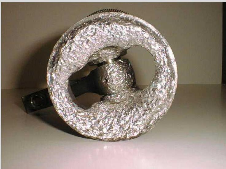
Durch Abriß des Ventiltellers durchgeschlagener Kolben
