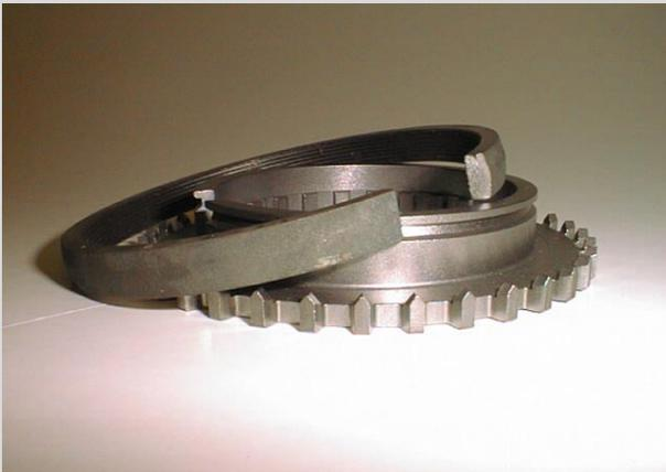
Schalt- und Führungsmuffen hingegen sollten genau überprüft, und bei Verschleiss erneuert werden. Die Schaltmuffe ist bei Verschleiss in jedem Fall zu erneuern, zumal diese nicht nur für den mühelosen und geräuschfreien Gangwechsel verantwortlich ist,
