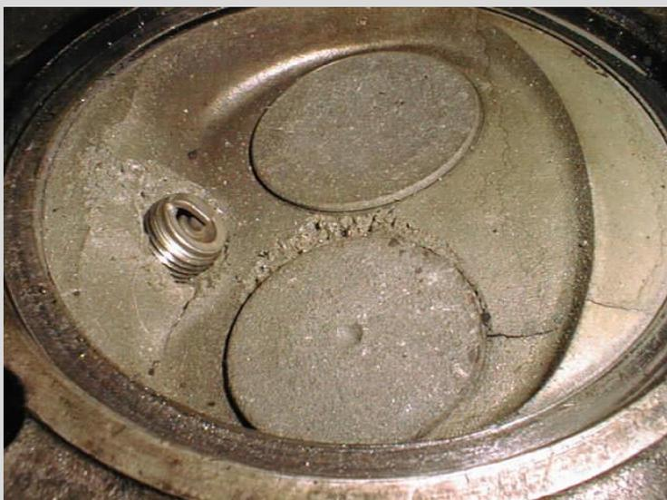
Abbrand durch Überhitzung und Rißbildung beim 2,0 l Vierzylinder-Motor eines 912E
