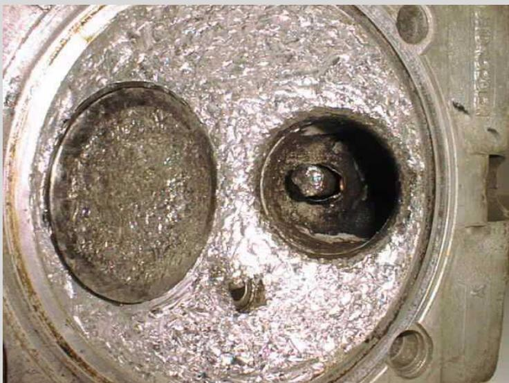
Eine verschlissene Ventilführung führte hier zum Abriß des Ventils. Gut zu sehen: der papierdünne untere Rand der Führung.
